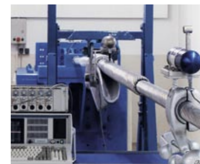
Ensayo de vibraciones para el proyecto del cruce del bósforo en 380 kV Teste de vibração no projeto do cruzamento do Bosforo em 380 kV
